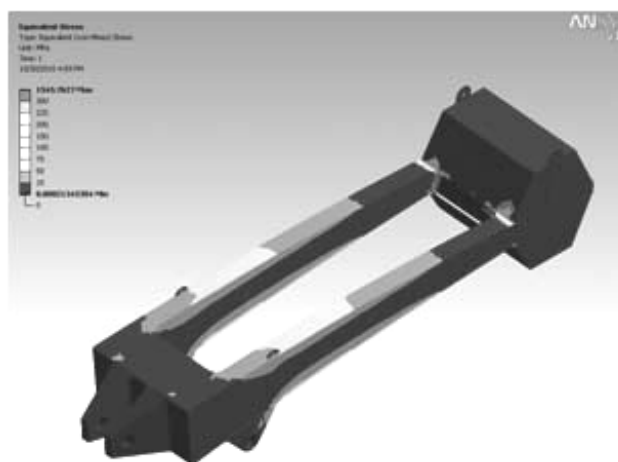
Рис. 5. Напряженно-деформированное состояние коромысла подвижного противовеса без добавочного груза
