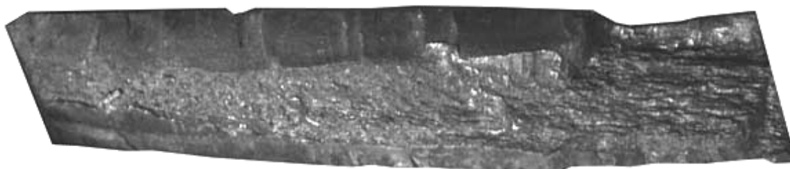
Рис. 2. Поверхность разрушения зуба
